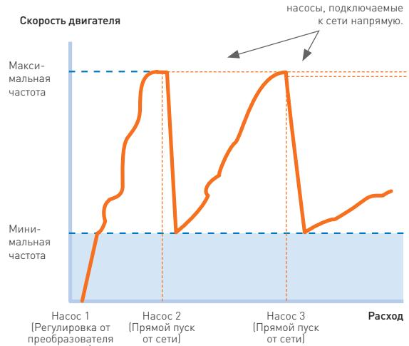
Решение Multipump с одним преобразователем частоты.
