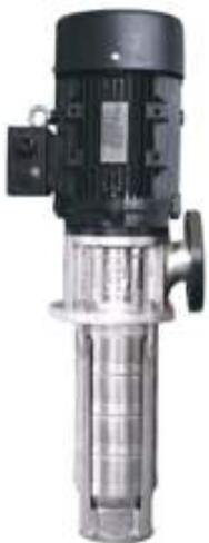
Линейка вертикальных многоступенчатых полупогружных насосов с нижним забором воды и верхним расположением напорного патрубка. Имеют различные исполнения по материалу проточной насосов - из нержавеющей стали разных марок. Тип присоединения к трубопроводу – резьбовое (CDLK(F) 1,2,3,4,8,16,20) и фланцевое (CDLK(F) 32,42). Электродвигатель IP55, класс изоляции F. Напряжение электродвигателя 380В (Pmax=45 кВт).
