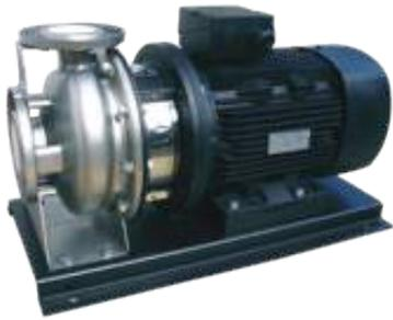
Линейка консольно-моноблочных насосов с горизонтально расположенным коротким валом, осевым всасывающим и радиальным напорным патрубками. Материал корпуса (рабочего колеса) из нержавеющей стали. Тип присоединения к трубопроводу – резьбовое (SO, SC, MS) и фланцевое (ZS). Электродвигатель IP55, класс изоляции F. Напряжение электродвигателя 380В (Pmax=37 кВт).
