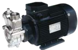
Линейка горизонтальных одноступенчатых смесительных насосов. Исполнение по материалу проточной насосов - из нержавеющей стали AISI304. Тип присоединения к трубопроводу – резьбовое. Электродвигатель IP55, класс изоляции F. Напряжение электродвигателя 380В (Pmax=7,5 кВт).
