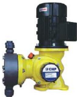
Линейка дозировочных диафрагменных насосов объемного типа. Материал корпуса (рабочих органов) из химически стойких материалов. Тип присоединения к трубопроводу – при помощи специальных соединений. Электродвигатель IP55, класс изоляции F. Напряжение электродвигателя 220В или 380В (Pmax=0,75 кВт).
