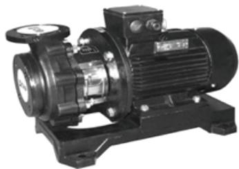
Линейка консольно-моноблочных насосов с горизонтальным расположением вала, осевым всасывающим и радиальным напорным патрубками. Материал корпуса (рабочего колеса) из химически стойких материалов. Тип присоединения к трубопроводу – фланцевое. Электродвигатель IP55, класс изоляции F. Напряжение электродвигателя 380В (Pmax=18,5 кВт).
