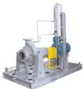
Линейка консольных насосов с горизонтальным расположением вала, осевым всасывающим и радиальным напорным патрубками. Материал корпуса (рабочего колеса) из химически стойких материалов. Тип присоединения к трубопроводу – фланцевое.
