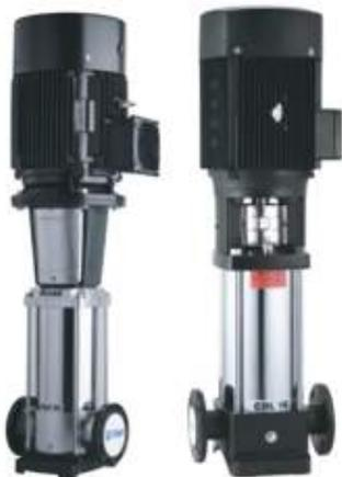
Линейка вертикальных многоступенчатых насосов с соосным расположением всасывающих и напорных патрубков. Имеют различные исполнения по материалу всасывающих (напорных) патрубков насосов - из нержавеющей стали разных марок или чугуна. Тип присоединения к трубопроводу – фланцевое (возможны варианты – овалный фланец, резьба, муфта – в зависимости от модели). Электродвигатель IP55, класс изоляции F. Напряжение электродвигателя 220В (Pmax=2,2кВт) и 380В (Pmax=110 кВт).
