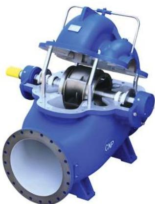
Линейка одноступенчатых насосов двухстороннего входа с горизонтальным расположением вала, осевым всасывающим и радиальным напорным патрубками. Материал корпуса (рабочего колеса) из чугуна, рабочего колеса из нержавеющей стали (бронзы) по специальному запросу. Тип присоединения к трубопроводу – фланцевое. Электродвигатель IP55, класс изоляции F. Напряжение электродвигателя 380В (Pmax=200 кВт) и 6кВ (Pmax=1000 кВт).
