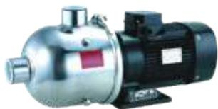
Линейка горизонтальных многоступенчатых несамовсасывающих насосов оснащенных торцевым уплотнением вала. Имеют конструктивные отличия по типу ступени и различные исполнения по материалу всасывающих (напорных) патрубков насосов - из нержавеющей стали разных марок или чугуна. Тип присоединения к трубопроводу – резьбовое. Электродвигатель IP55, класс изоляции F. Напряжение электродвигателя 220В (Pmax=2,2кВт) и 380 В (Pmax=5,5 кВт).
